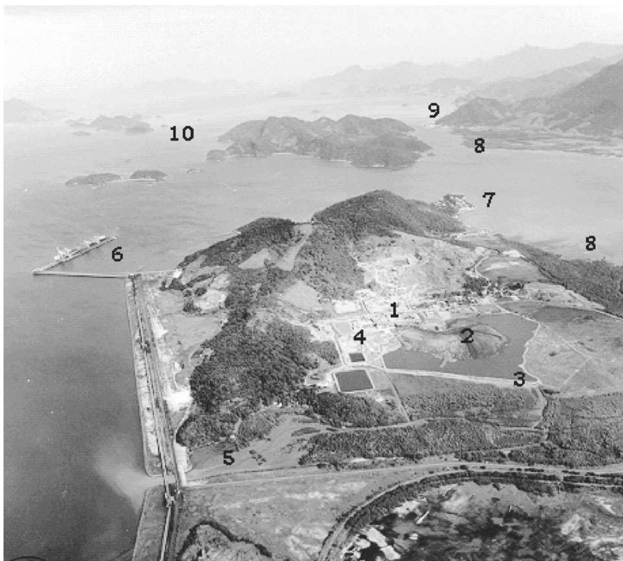
Figura 2: Fotografia aérea da Ilha da Madeira e Baía de Sepetiba (cedida pela My Zoom fotografias). Na figura são destacados: 1 - planta de produção da Ingá, 2 - pilha de rejeitos, 3 - dique de contenção, 4 - estação de tratamento de efluentes, 5 - Saco do Engenho (observar a passagem de sedimentos contaminados para a Baía de Sepetiba sob a ponte rolante do porto), 6 - Porto de Sepetiba, 7 - Comunidade de pescadores da Ilha da Madeira, 8 - mangues usados para pesca e mariscagem, 9 - bairro de Itacuruçá com comunidades de pescadores, 10 - ilhas turísticas.
